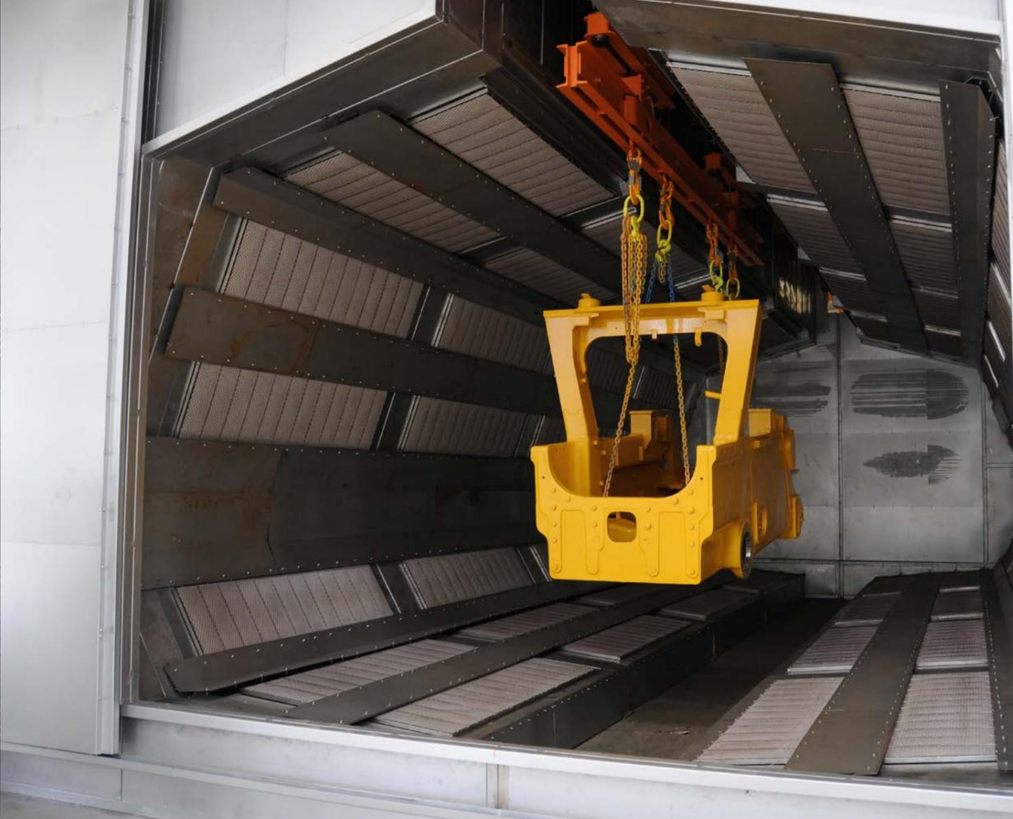
LOS PANELES CATALÍTICOS INFRARROJOS INFRACAT®, CUYA MARCA EXPLÍCITA LA UNIÓN ENTRE ENERGÍA INFRARROJA Y TECNOLOGÍA CATALÍTICA, SON CARACTERIZADOS POR TEMPERATURA SUPERFICIAL MODULABLE DE 180°C A 550°C.
